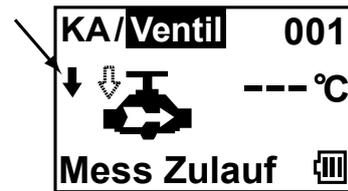
5) Falls nach einer Messung am Ventilaustritt das Display das rechts gezeigte Muster anzeigt, sind weitere Messungen notwendig. Die zweite Messung wird dann ungefähr 50 cm vor dem Ventil gemacht.
