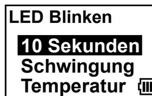
Anmerkung: Bei Wälzlagerprüfungen hört der Messvorgang nicht auf, wenn die LED Anzeige blinkt. Das Blinken stoppt nach Ablauf von 1 Minute, oder wenn die Messsonde vom Messpunkt abgehoben wurde.
