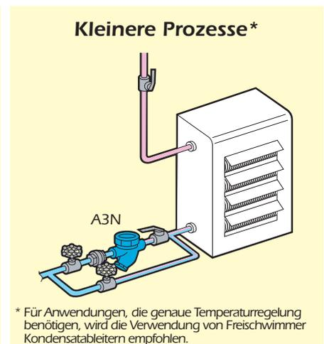
\* Für Anwendungen, die genaue Temperaturregelung benötigen, wird die Verwendung von Freischwimmer Kondensatableitern empfohlen.
