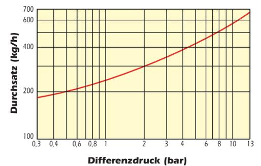
1. Der Differenzdruck ist die Differenz des Druckes vor und nach dem KA.
