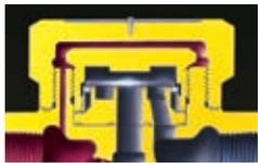
Thermodynamische Kondensatableiter ohne Isolierkappe verlieren bei schlechter Witterung schnell Wärme über die Verschlusskappe, was Dampfverlust
