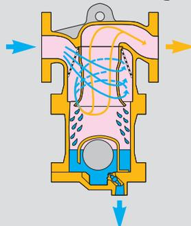
**1** Fluid tritt in den Abscheider ein und wird mittels einer ausgeklügelten Gestaltung des Leitapparates in eine zyklonförmige Strömung mit hoher Geschwindigkeit gebracht, wodurch selbst nebelförmiges Kondensat abgesondert wird.
