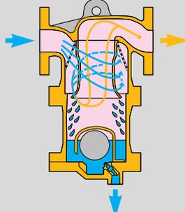
**1** El fluido ingresa en la entrada del separador, y un conjunto complejo de aletas cambia el flujo de vapor o aire convirtiéndolo en un flujo ciclónico de alta velocidad, separando aún el condensado más disperso contenido en el flujo.
