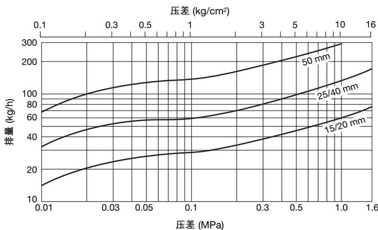
1. 排量是指低于饱和蒸汽温度6°C时冷凝水连续排放量的最大值。
