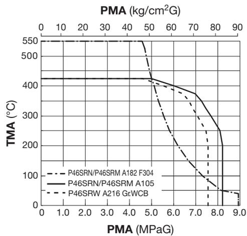
\* 这个曲线图是基于 ASTM 材料在每个温度下的对应压力值
